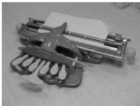
Obr. 9.1: Pichtův psací stroj Tatrapoint adaptive 1
